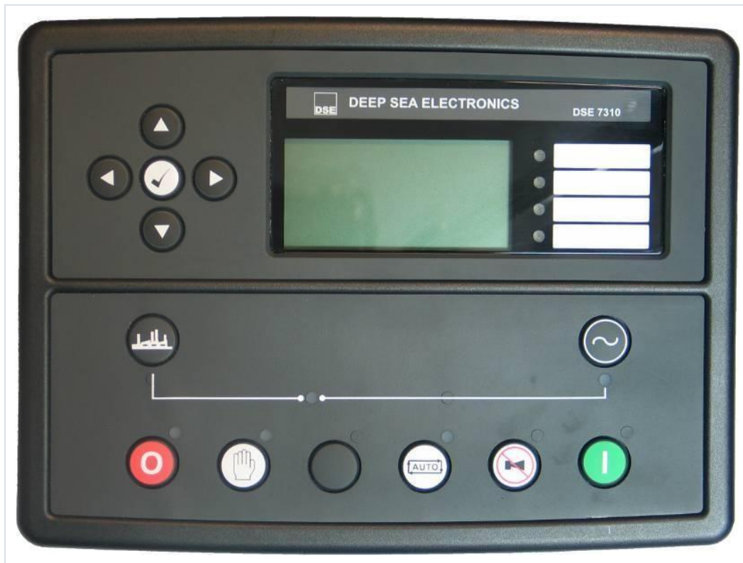
Контролер DSE 7310 — панель навігації, конфігуровані світлодіоди та органи керування START, AUTO, MANUAL і STOP.
